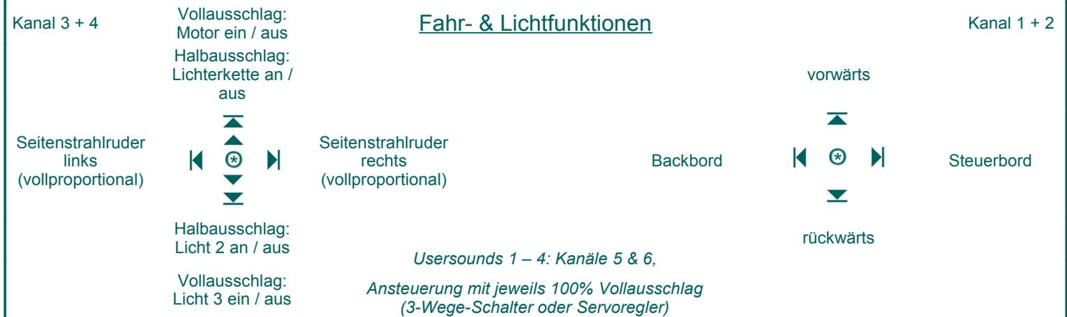
Bevor Sie eventuell die Kanäle / Steuereinheiten für Ihre Funkfernsteuerung abändern, sollten Sie die hier vorgeschlagene Konfiguration zuerst installieren, um sich mit den Funktionen und Steuermöglichkeiten dieses Moduls vertraut zu machen. Sind alle Funktionen zu Ihrer Zufriedenheit können sie die Ansteuerung Ihrer Fernsteuerung wunschgemäß abändern und so eventuell auftauchende Probleme deutlich eingrenzen. Lesen Sie dazu vorher die Bedienungsanleitung Ihrer Fernsteuerung sorgfältig durch.
